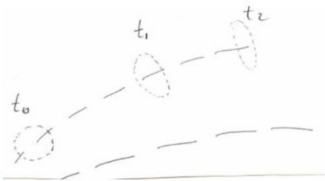
Σχήμα 4.11: Σχ. 4.11. Παραμόρφωση υλικού όγκου κατά την ροή κατά μήκος μιας ροικής γραμμής.
